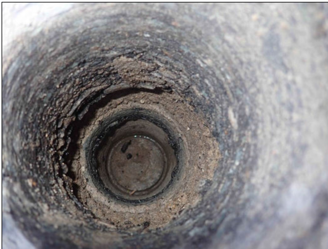
Foto 1: Pohled do provedeného vrtu V8 pro stanovení skladby komunikace.
