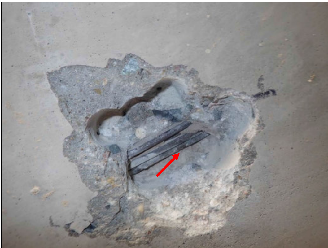
Foto 27: Detail sondy S27, předpínací výztuž nosník KA 61, spodní líc nosníku č. 11, cca 1/2 rozpětí. Na předpínací výztuži nebyla nalezena koroze. Kanálek zcela vyplněn injektážní směsí. Krytí předpínací výztuže cca 40 mm. Poloha viz Příloha 1.
