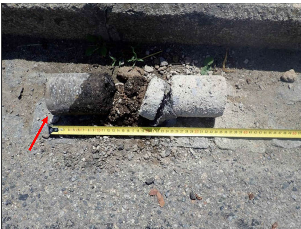
Foto 2: Pohled na výnosu z vrtu V8 pro stanovení skladby komunikace. Šípkou vyznačen horní líc komunikace.
